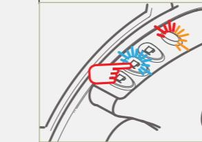
9. A máquina distribui a solução descalcificante em intervalos (5 distribuições intercaladas por uma pausa de 10 minutos, com a duração de 45 minutos aproximadamente). Durante esta fase, as teclas não devem ser pressionadas e a luz indicadora multifunções pisca alternadamente (VERMELHO e LARANJA).
