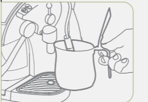
2. Rodar a alavanca de comando totalmente para a direita. Deste modo, a água residual presente no circuito é escoada.
