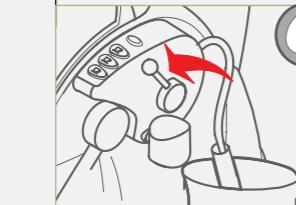
3. Para terminar a distribuição, rodar a alavanca para a direita e colocá-la na posição central.
