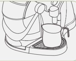
6. Certificar-se de que a alavanca está abaixada e de que não haja uma cápsula no interior do compartimento de introdução de cápsulas.
