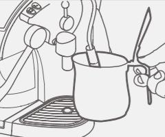
2. Rodar a alavanca de comando totalmente para a esquerda. Iniciar a distribuição da água quente.
